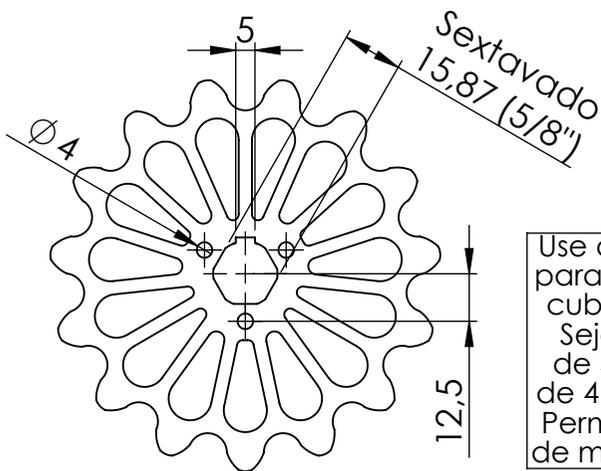
Use as fixações internas para desenvolver novos cubos para as coroas. Seja pelo sextavado de 5/8" ou pelos furos de 4mm para parafuso. Permitindo assim, o uso de montagens variadas.
